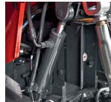
> RELEVAGE HYDRAULIQUE AR À DOUBLE EFFET
