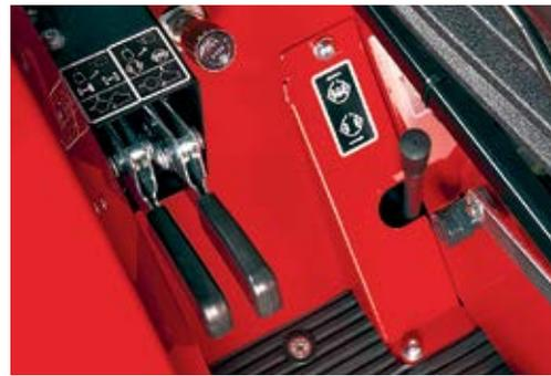
**BLOCAGE DIFFÉRENTIEL ET DÉBRAYAGE TRACTION**
